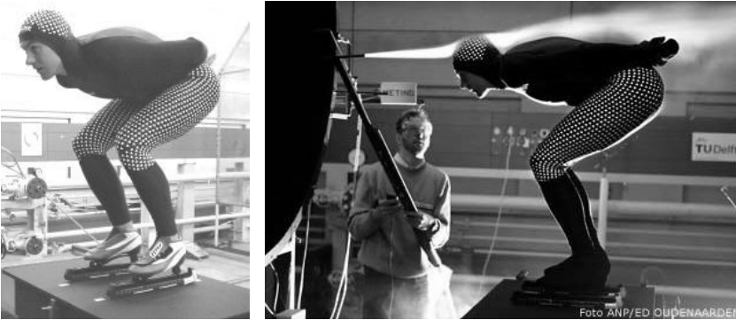
Figuur 8. De Pool Pavel Zygmunt in de windtunnel tijdens proeven aan een pak met driehoekige applicaties en verschillende stoffen op armen en benen
